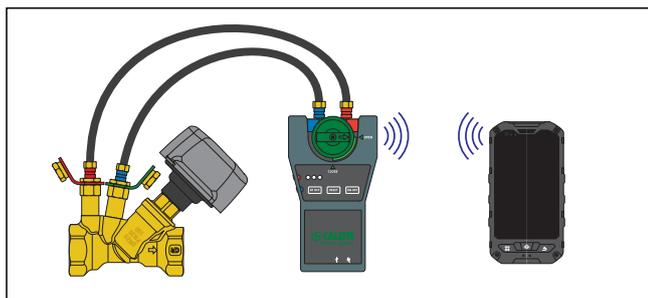
Терминал, поставляемый в упаковке, уже снабжен программным обеспечением Caleffi Balance, в которое загружены все данные относящиеся к балансировочным клапанам Caleffi и основным моделям балансировочных клапанов имеющихся в продаже. Устройство позволяет производить измерения, в соответствии с ранее описанными методами, выводить на экран результаты и сохранять их в памяти.
