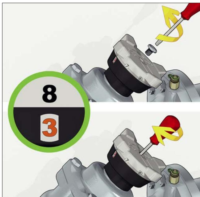
Для размеров Ду 200÷Ду 300, внутренний торцевой винт (шестигранник 6 мм) «memory stop» находится под центральной защитной заглушкой.
